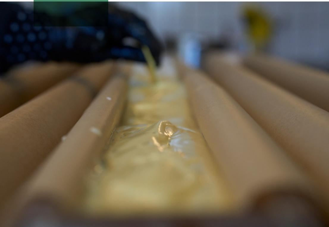
*Die gesiedete Seife wird in lange rechteckige Formblöcke gegossen, um sie nach Trocknung in die typische Form zu schneiden.*
